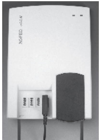
Abb. 4: TK-Anlage mit gesteckter Stromversorgung, ISDN-Anschluss und TAE-Stecker
