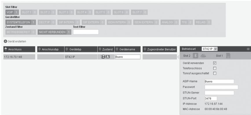
Geben Sie unter „Passwort“ das Passwort ein, was Sie auch in Ihrem ASIP-Endgerät hinterlegt haben. Nach erfolgreicher Anmeldung wird nun das rote „A“ Symbol blau, und dem Endgerät wird automatisch ein neuer Benutzer zugewiesen. Das Endgerät ist betriebsbereit.
