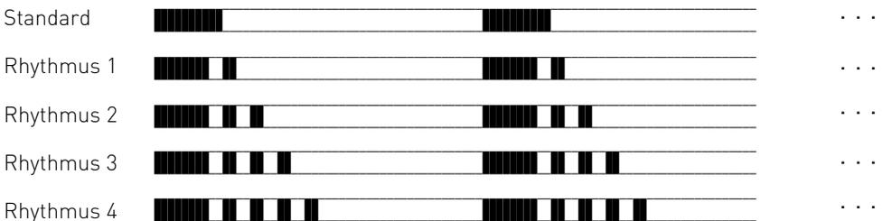
Je nach verwendetem Endgerät können die Rufe abweichen. An Ports, die als Endgerädetyp "Funkzelle" eingerichtet sind, werden die Rufrythmen 3 und 4 nicht signalisiert.
