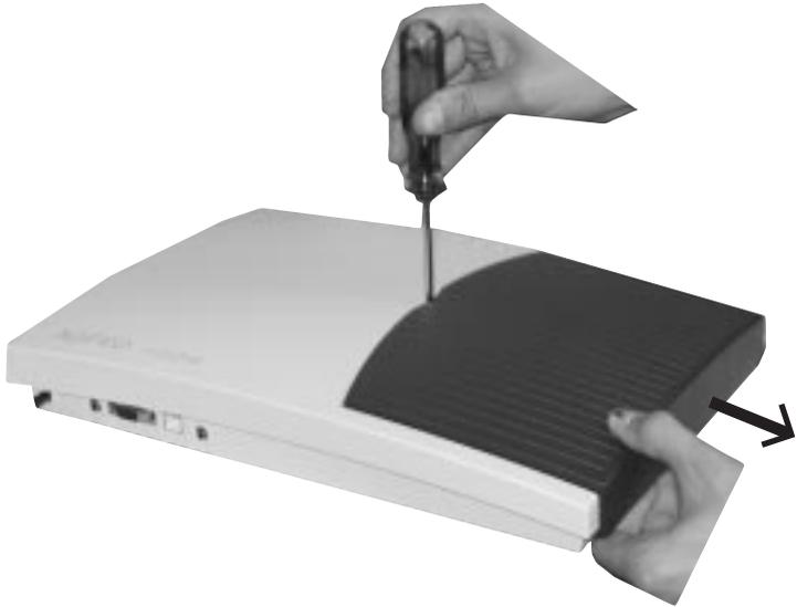
**! ACHTUNG: Vor dem Öffnen des Gehäuses - 230 V-Netzstecker der TK-Anlage aus der Steckdose ziehen!**
