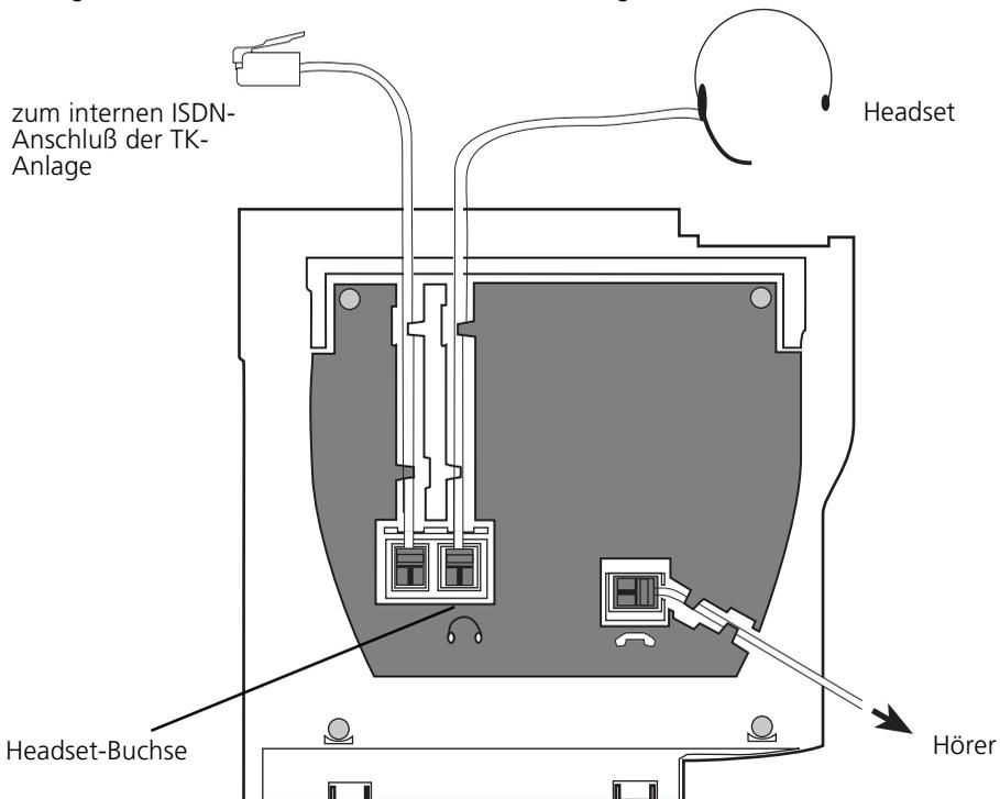
Anschlüsse an der Unterseite des digitalen Systemtelefons ST 25
