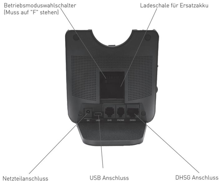
AGFEO empfiehlt zum Anschluss der Basis an Ihrem Systemtelefon ein Patchkabel (1:1) mit einer maximalen Länge von 100 cm, um eventuelle Störeinstrahlungen zu vermeiden. Bitte beachten Sie, dass das Kabel auf einer Seite über einen kurzen Stecker verfügen sollte.
