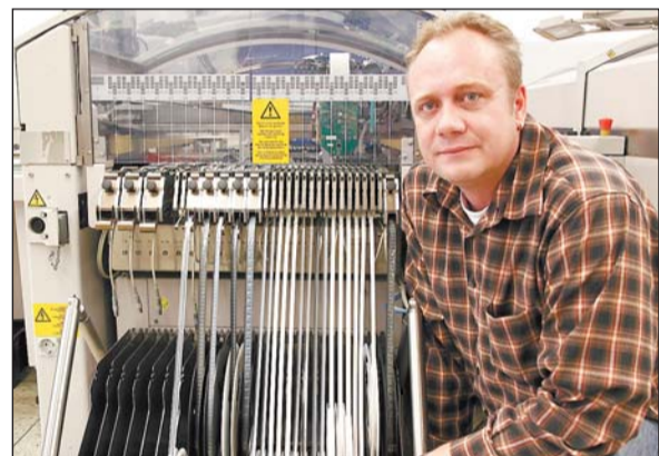
»17 000 Bauteile pro Stunde – das ist die Leistung dieser Maschine, die Leiterplatten bestückt«, erzählt Betriebsleiter Jens Beckstette.
